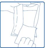
Verificar se existem vazamentos comprimindo firmemente a bolsa interna.
